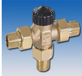
Рис.7 Трехходовой разделительный клапан Heimeier ДУ 25, 1"НР, Kvs=4.6
