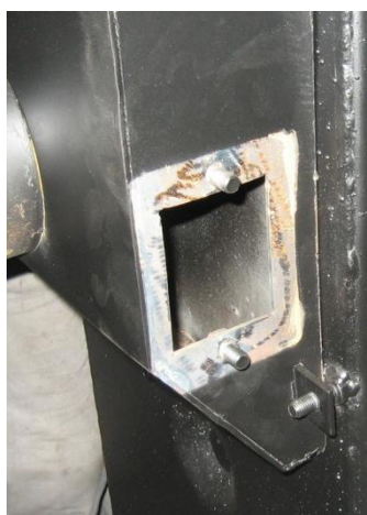
Рис. 10. Отверстие для чистки адаптера дыма.
