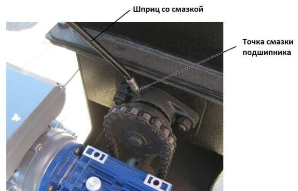
Рис. 8. Смазка подшипников шнековой подачи.
