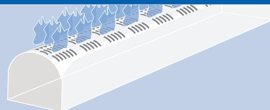
Поскольку газ сжигается в виде отдельных факелов, пламя не контактирует с трубкой горелки, которая не нагревается и поэтому прослужит дольше.
